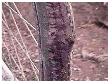
自行车外胎裂口达1厘米，由于胎内衬有外胎条，所以还能骑一阵子
